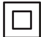
В целях обеспечения Вашей безопасности настоящий прибор оснащен двойной изоляцией. **CE**
