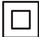
Dieses Gerät ist zu Ihrer Sicherheit mit einer doppelten Isolierung ausgestattet. **CE**
