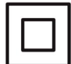
Ze względu na bezpieczeństwo użytkowników niniejsze urządzenie zostało wyposażone w podwójną izolację. **CE**
